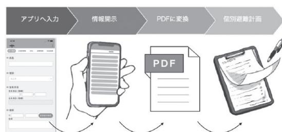
図1 K-DiPS Soloのスタンドアロン運用のフロー
